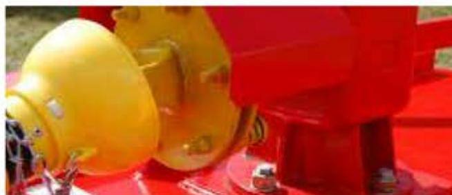
Caja de transmisión para servicio pesado y barra protegida por un zafe de discos ajustables que acciona al existir sobrecargas.
