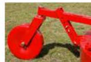
Rueda de apoyo trasera de hierro, altura regulable. Plataforma plegada en chapa de 5 mm de espesor.
