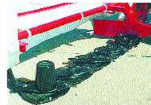
Equipada con 5 discos de alta velocidad de corte de 2950 RPM. Equipped with 5 discs 2950 RPM high-speed cutting
